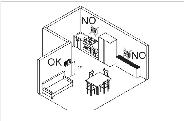
Le contrôle mural doit être installé :
