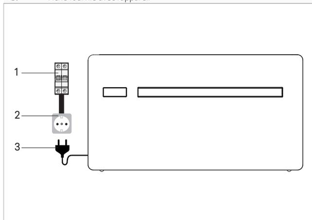
En cas de nécessité, le câble à fiche du fabricant peut être remplacé par une alimentation électrique directement reliée au bornier (branchement conseillé pour l'installation de l'appareil sur le haut du mur).
