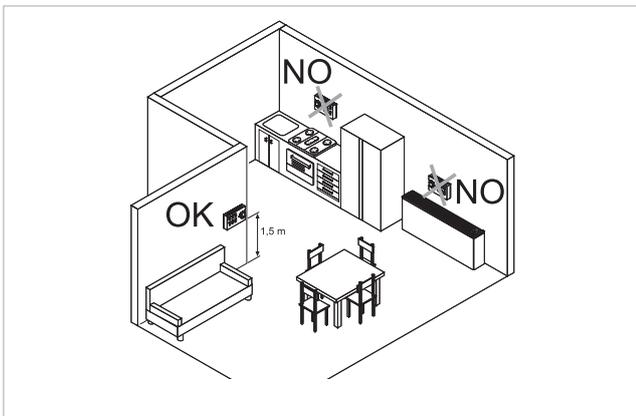
Le contrôle mural doit être installé :
