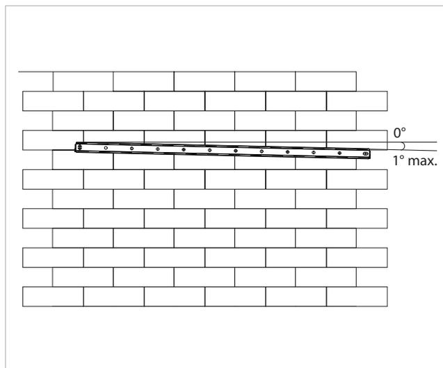
⚠ Une inclinaison maximale de 1° vers le côté droit de l'appareil est autorisée pour faciliter l'évacuation des condensats.
