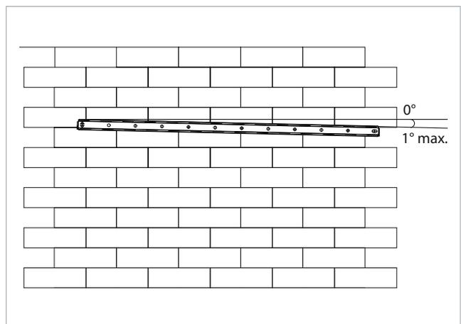
⚠ À l'aide d'un niveau à bulle, vérifier que l'installation est bien horizontale.
